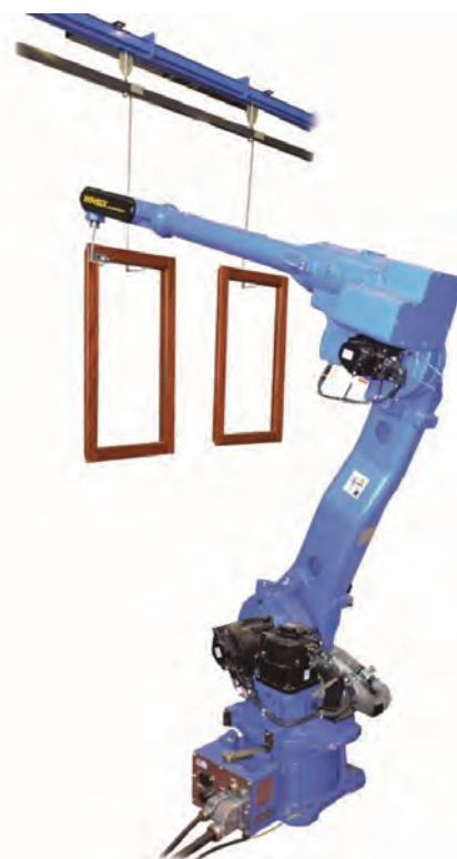
WINSIX LAKIERUJĄCY ELEMENTY NA PODWIESZANYM TRANSPORTERZE
