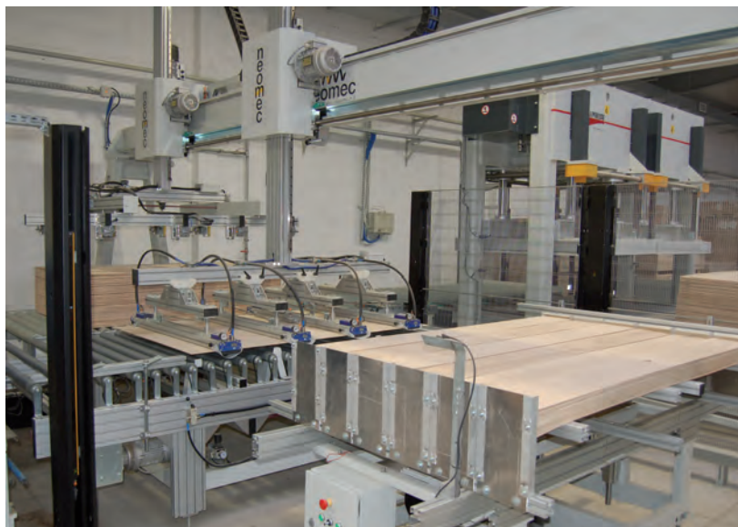
PRECYZYJNY SYSTEM AUTOMATYCZNEGO UKŁADANIA LAMELI NA SKLEJCE, A NASTĘPNIE SZTAPLOWANIA PRZED WEJŚCIEM DO PRASY.
