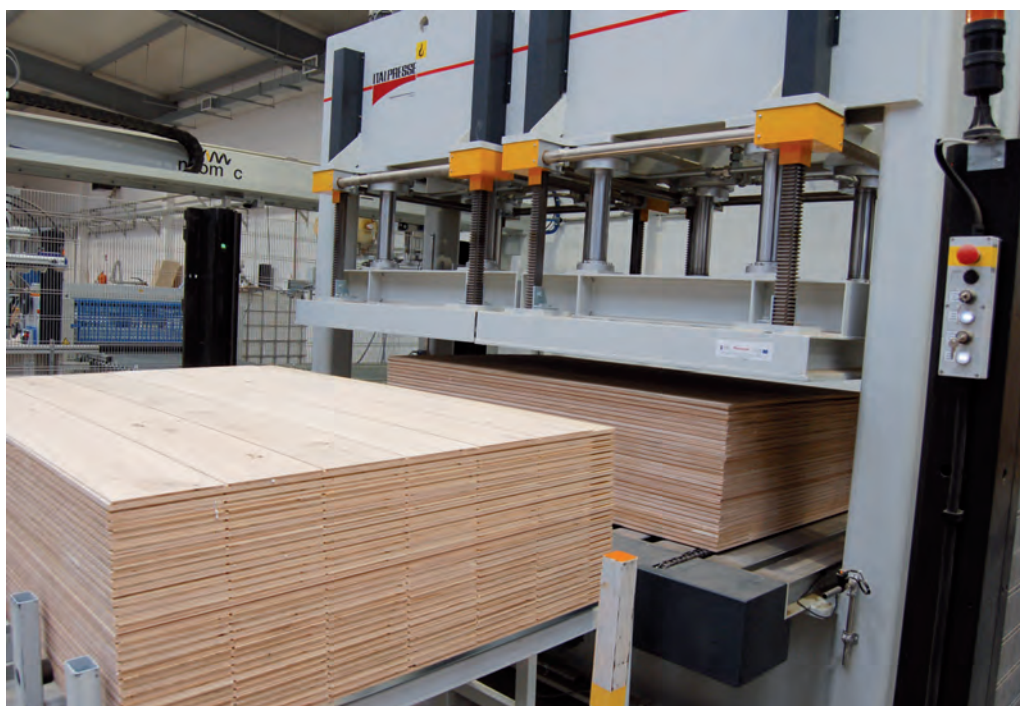
PRASA NA ZIMNO Z DZIELONĄ PÓŁKĄ, DO OBRÓBKİ DŁUGIEJ DESKI LUB DWÓCH KRÓTKICH W TYM SAMYM CZASIE.
