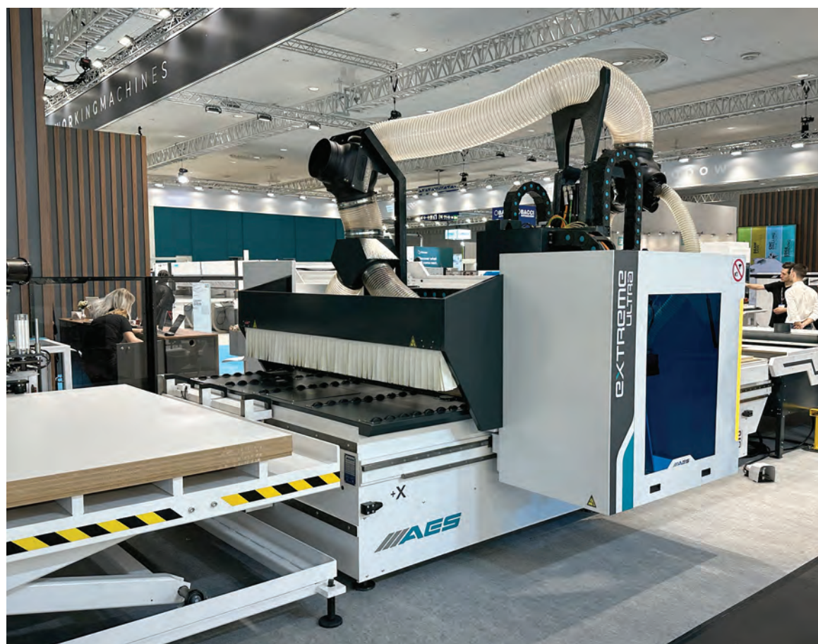
CENTRUM OBRÓBCZE MOD. EXTREMA ULTRA Z AUTOMATYZACJĄ ZAŁADUNKU I ROZŁADUNKU
